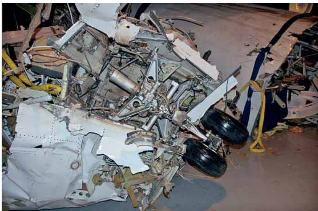
Foto 59: parte anteriore fusoliera, carrello di atterraggio anteriore.
