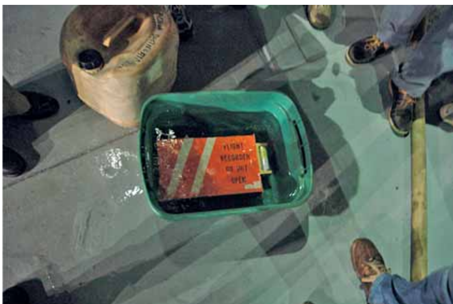
Foto 27: CVR recuperato a bordo dell'aeromobile immerso in acqua distillata.
