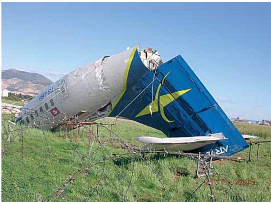
Foto 33: parte posteriore relitto, vista laterale destra.
