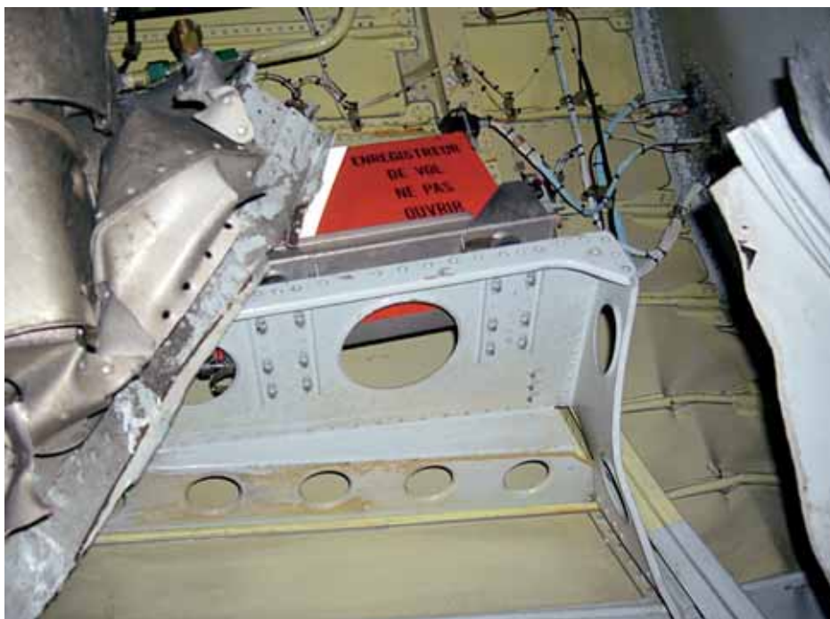
Foto 26: CVR nel suo alloggiamento a bordo dell'aeromobile.
