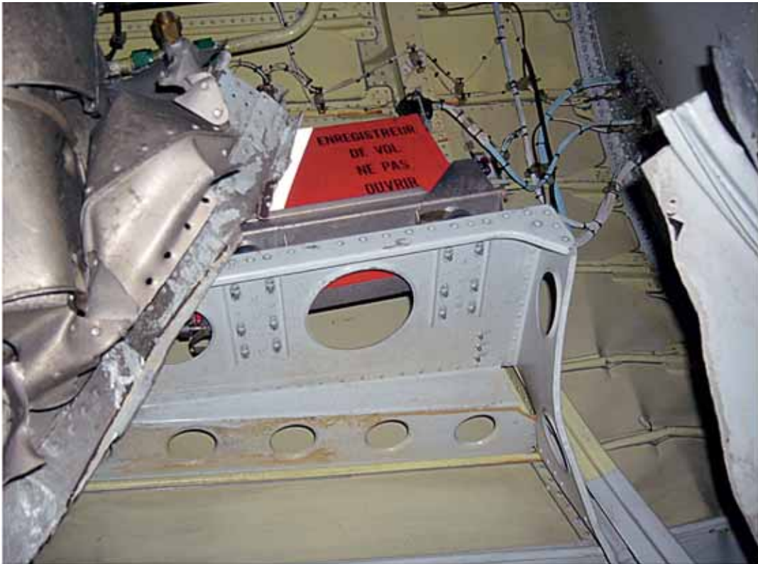
Foto 62: CVR nel suo alloggiamento.
