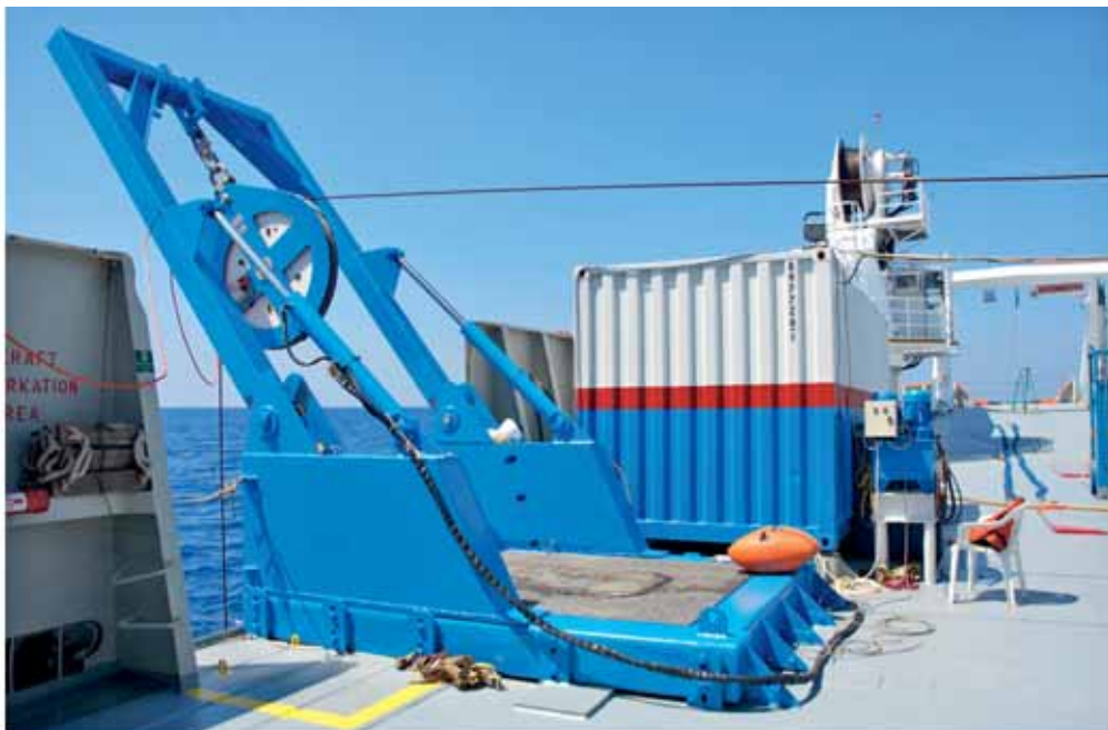
Foto 48: sistema di messa in mare del Remora 6000.
