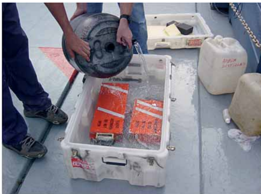
Foto 17: conservazione FDR e CVR in acqua distillata.
