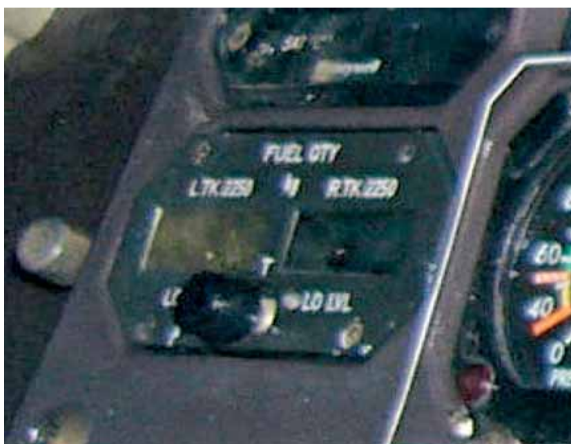
Foto 87: FQI installato a bordo del TS-LBB effettuata subito dopo il recupero del relitto.
