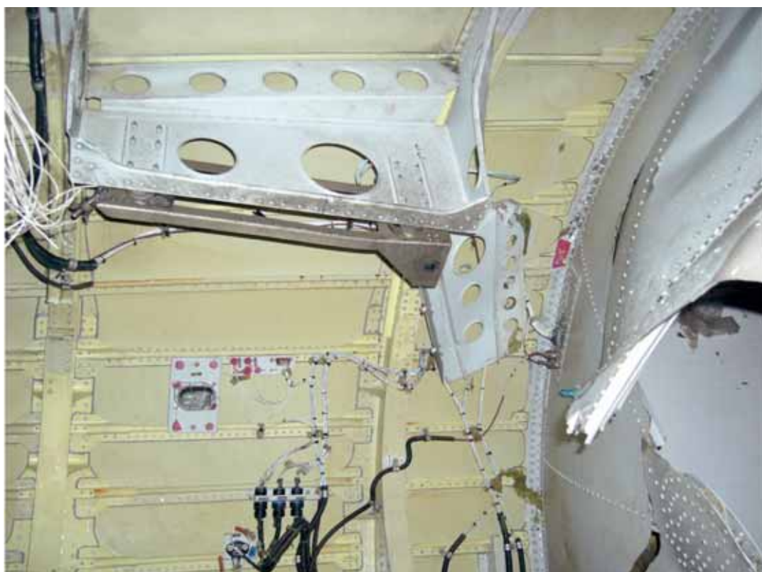
Foto 61: alloggiamento del FDR (notare la deformazione della paratia cosiddetta pressure bulkhead , a testimonianza del forte impatto della parte posteriore dell'aeromobile).
