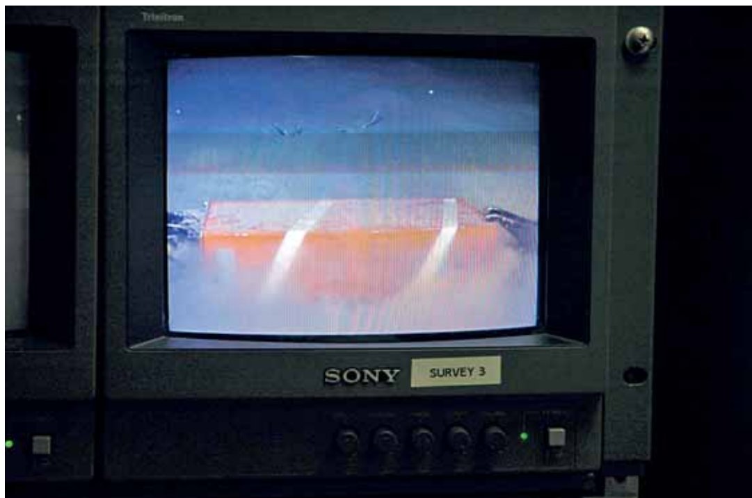
Foto 64: recupero del FDR da parte del ROV.
