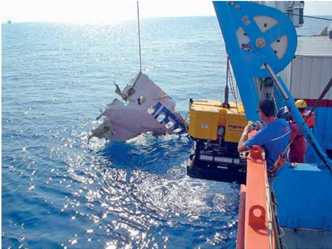
Foto 67: recupero del pannello di fusoliera parte destra aeromobile.
