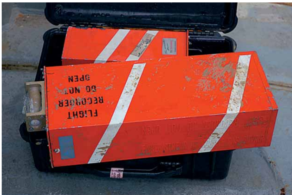
Foto 16: FDR (in primo piano) e CVR recuperati.
